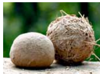
Vielseitiges Material: Lehm lässt sich als Mörtel und Putz, auch mit Stroh vermischt, oder als Ziegel, luftgetrocknet oder gebrannt, verwenden
