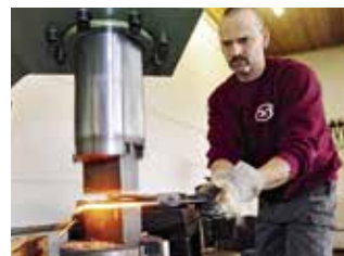
Der Kirchturmuhrbauer Gordian Meinrad Pechmann prüft ein Ziffernblatt (oben). Sein Mitarbeiter schmiedet einen Glockenhammer (unten)
