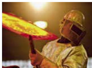
Beim Glockenguss fließt 1100 Grad heiße Bronze in eine Lehmform. Nach dem Guss kühlen die fertigen Glocken in der Glockengrube aus
